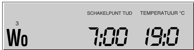
figuur 10: Een willekeurig schakelpunt op het display
